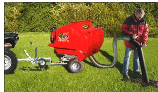
PC mit 750 l-Behälter, Drehgestell und Kippvorrichtung
