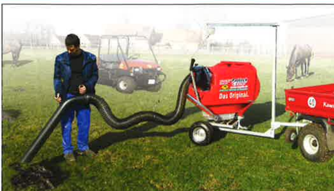
PC mit 450 l-Behälter, Drehgestell und Kippvorrichtung
