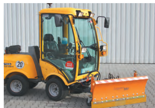
bema Schneeschild Serie 550, Frontmäheranbau
