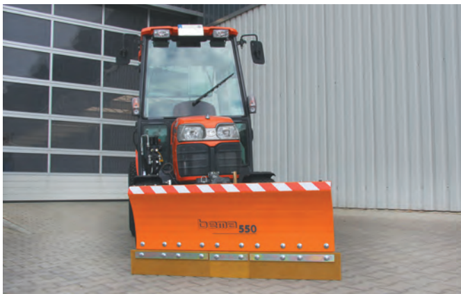
bema Schneeschild Serie 550, Anbau Kompaktschlepper (Dreipunktbock)
