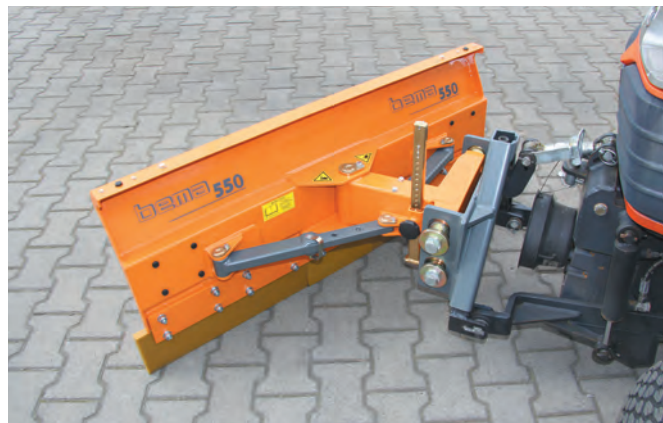
bema Schneeschild Serie 550, mechanische Winkeleinstellung
