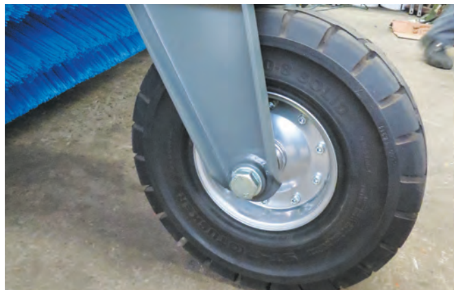
Stabile Laufräder (Ø 460 x 145 mm)
