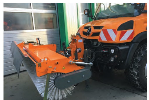
Unimog-Anbau, hydraulischer Aushub
